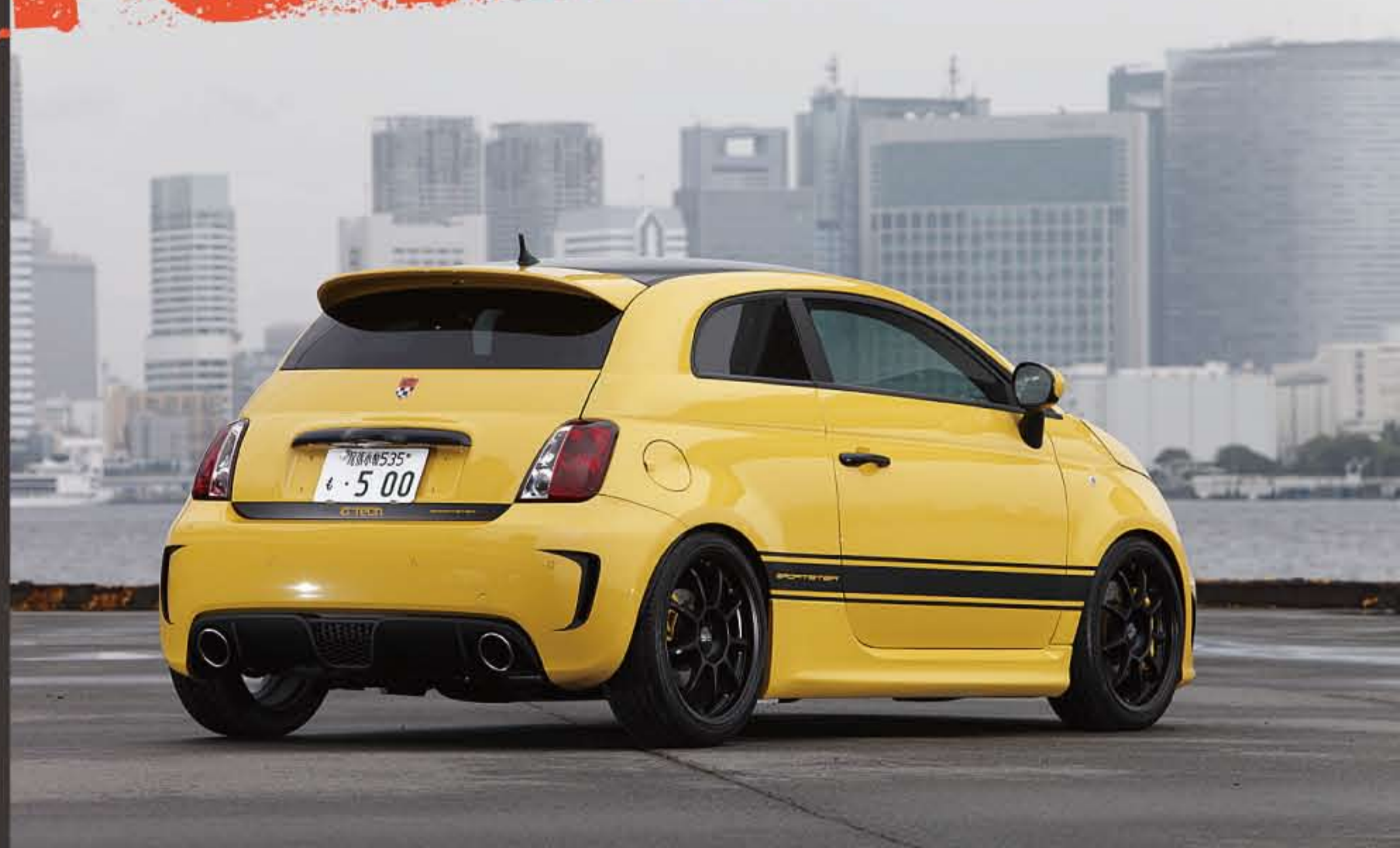
サイドとリアのウィンドーはアクリル製となっている。チョップドルーフ化にともない、ピラーやルーフだけでなく、ウィンドー類も全て専用設計されている。
