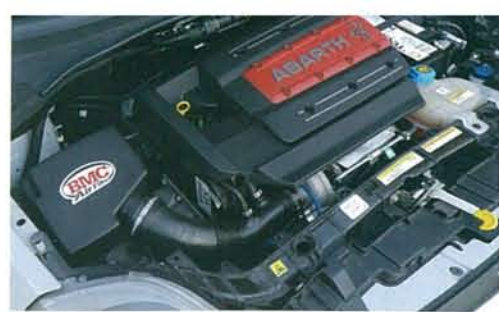
G-Techではサブコンを追加してパワーアップすることが多いが、Punto用はCPU本体のロムにもチューニングが施されたG-Techエンジン管理システムが採用されている。これにより点火時期や燃料噴射量など、より細かくセッティングが可能となる。
