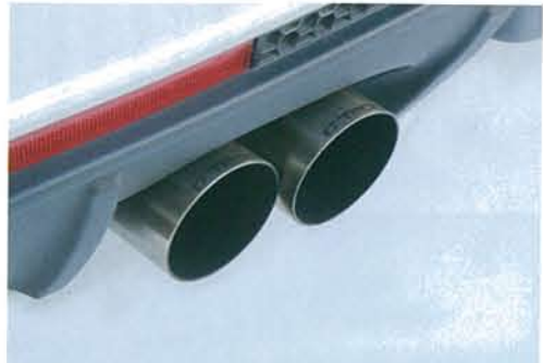
パフォーマンスキットにはG-Tech製エキゾーストシステムも含まれる。ステンレススチールで構成され、オリジナルの触媒を残し後方部分が変更される。排気効率を考慮して触媒とマフラーの結合部は70mmに拡大され、パワーアップに貢献している。
