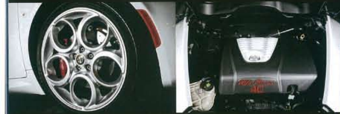
G-Tech 4C-280は現在、純正オプションサイズの前後205/40ZR18、後235/35ZR19というタイヤを履く。純正標準サイズのタイヤは前後205/45ZR17、後235/40R18だ。ブレーキキャリパーはフロントがプランギ製のモノブロックで、カラーも4色から選べる。サスペンション形式は前ダブルウィッシュボーン、後ストラットとなる。
