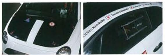
フロントバンネットの素材はノーマル同様アルミ製。開閉のためのキャッチとヒンジは付いておらず、ボンネットピンで固定されている。
