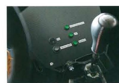
オリジナルのダッシュボードは取り外しカーボンパネルで形成。シフトノブ付近にあるパネルには電動ファンやトラクションコントロールなどのスイッチが備わる。トランスミッションは5速H Schaltung mit Dog Box Systemを採用。
