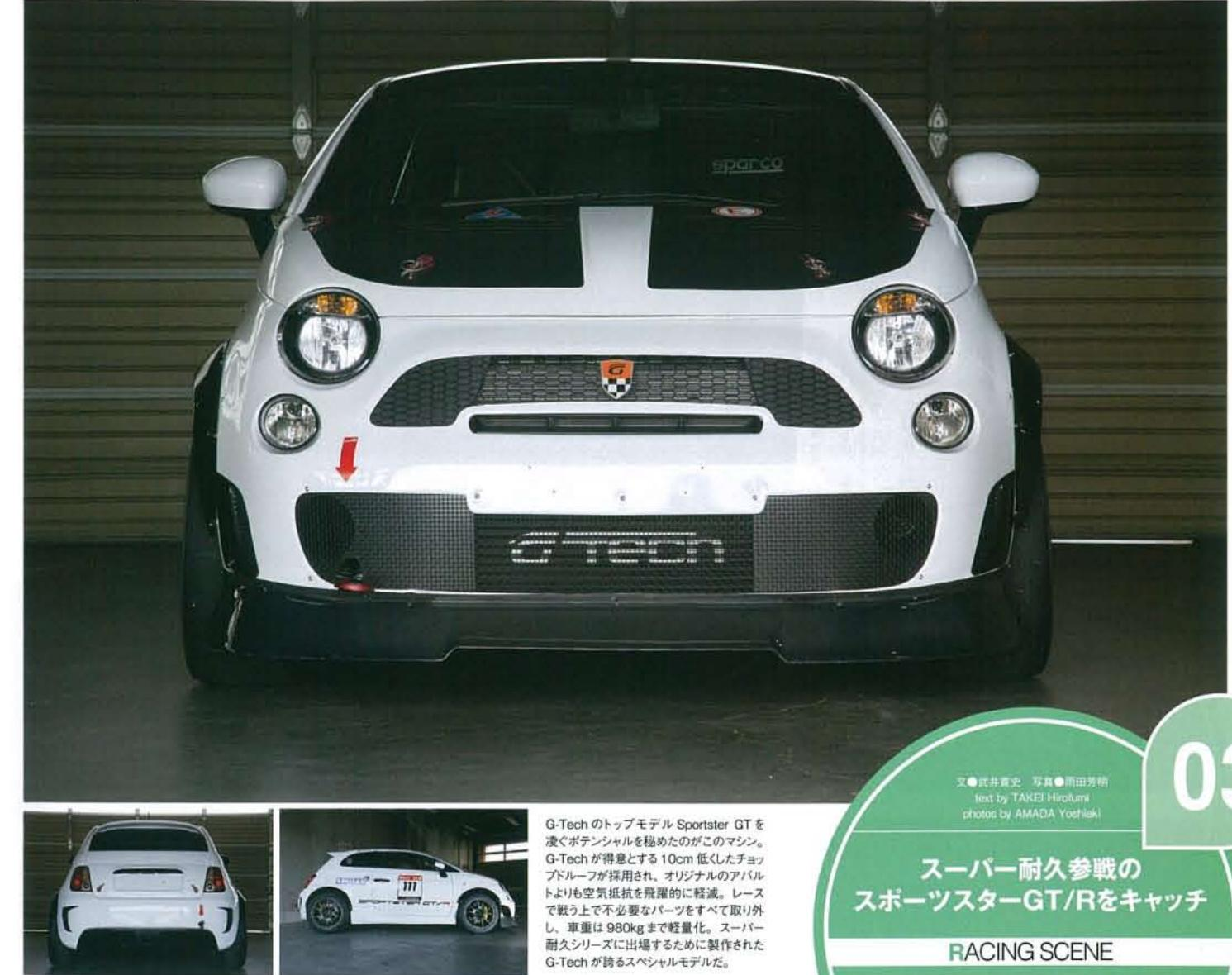
G-TechのトップモデルSportster GTを凌ぐボテンシャルを秘めたのがこのマシン。G-Techが得意とする10cm低くしたチョップブループが採用され、オリジナルのアバルトよりも空気抵抗を飛躍的に軽減。レースで使う上で不必要的パーツをすべて取り外し、車重は980kgまで軽量化。スーパー耐久シリーズに出場するために製作されたG-Techが誇るスペシャルモデルだ。
