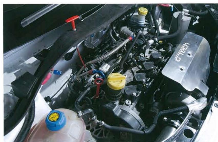
搭載されるエンジンはG-Techが開発したレース用エンジン。4気筒1368ccながら220psを発揮する。瞬発力と耐久性を兼ね備えたSpecialエンジンだ。
