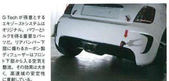
G-Techが得意とするエキゾーストシステムはオリジナル。パワーとトルクを得る重要なパートだ。リアバンパー下部に備わるカーボン製ディフューザーはフロント下部から入る空気を整流。その効果は大きく、高速域の安定性に貢献している。
