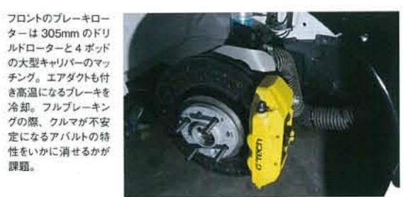
フロントのブレーキローターは305mmのドリルドローターと4ポッドの大型キャリパーのマッキンシング。エアクーラー付き高溫になるブレーキを冷却。フルブレーキングの際、クルマが不安定になるアバルトの特性をいかに消せるかが課題。
