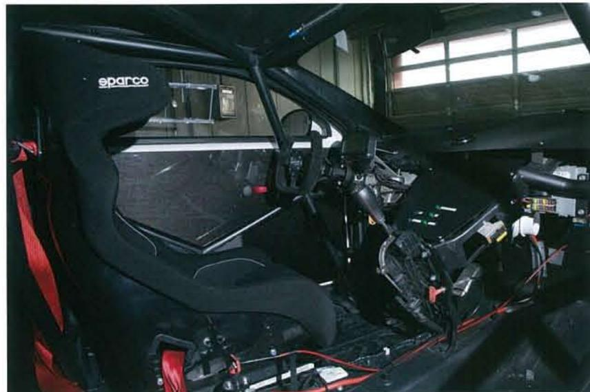
不要なパーツが取り外されたコクピットはとても簡素。ドア内部のパーツは全て廃し内貼りはカーボンパネルで製作。シートはスバルコ製のフルバケットとなる。
