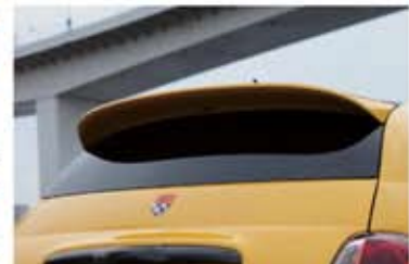
フロントウィンドウ以外のウィンドウは、軽量化も兼ねてすべてアクリル製に交換されている。もちろんチョップトップに合わせて専用デザインされたものとなる。
