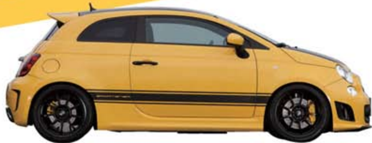
サイドビューからの眺めで、「Sportster GT」のチョップトップ具合が分かる。ピラーから上は100mm車高を下げるためにすべて作り直されているが、その美しいラインはあたかも純正のよう。
