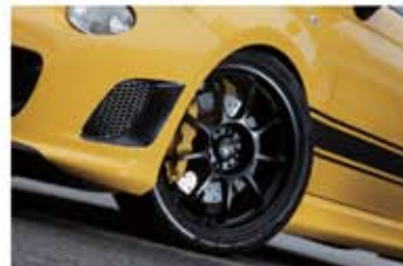
ホイールは「G-Tech Corsa」マットブラックの17インチ。タイヤは前後とも205/40R17。ブレーキは Brembo の4ポットで前 305φ、後 265φのドリルドロター。
