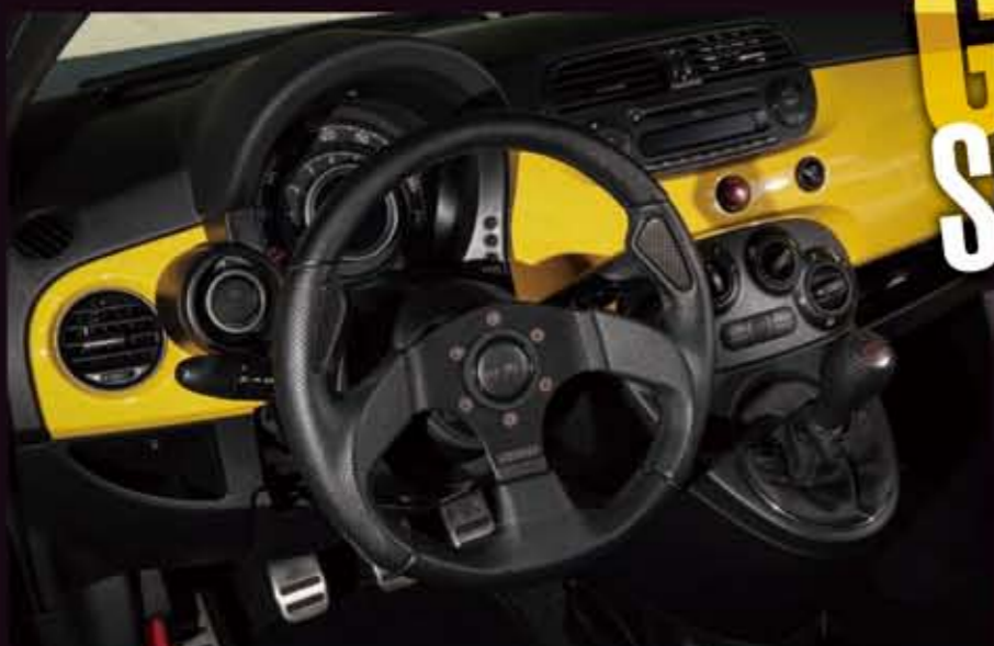
インテリアの見た目はアバルト500のそれに近いが、メーター本体とバイザーが低くセットされている。小径ステアリングはMOMO製。ミッションは5速マニュアル。
