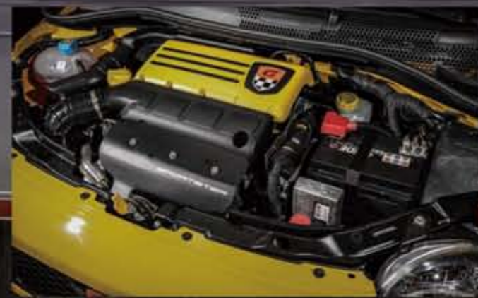
ギャレットの大径タービンを組み合わせたエンジンにハイブーストを掛けてパワーを湧き出しているため、耐久性が犠牲にならないよう、ローコンピストンが組まれている。燃料噴射量、点火時期などの各種マッピングは「G-Tech」のオリジナル。ブースト、トルク、スピードの各リミットもそれぞれ向上されている。
