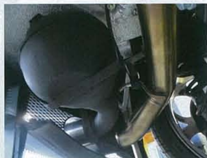
↑ パイプのヨコにセットされている丸みを帯びた黒い物体の中にスピーカーが仕込まれている。デジタルサウンドはスイッチによってオンとオフが設定できる仕組みとなる
