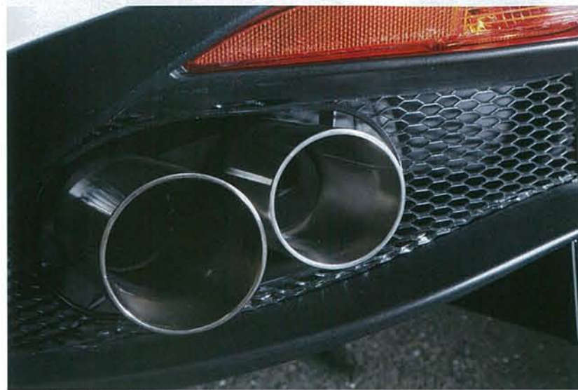
↑ 排気音のリアルなデジタルサウンドを奏でるエキゾースト・サウンドシステムはダブルのテールエンドが基本。右側からデジタル音を発し、左側からは通常の排気音を奏でる
