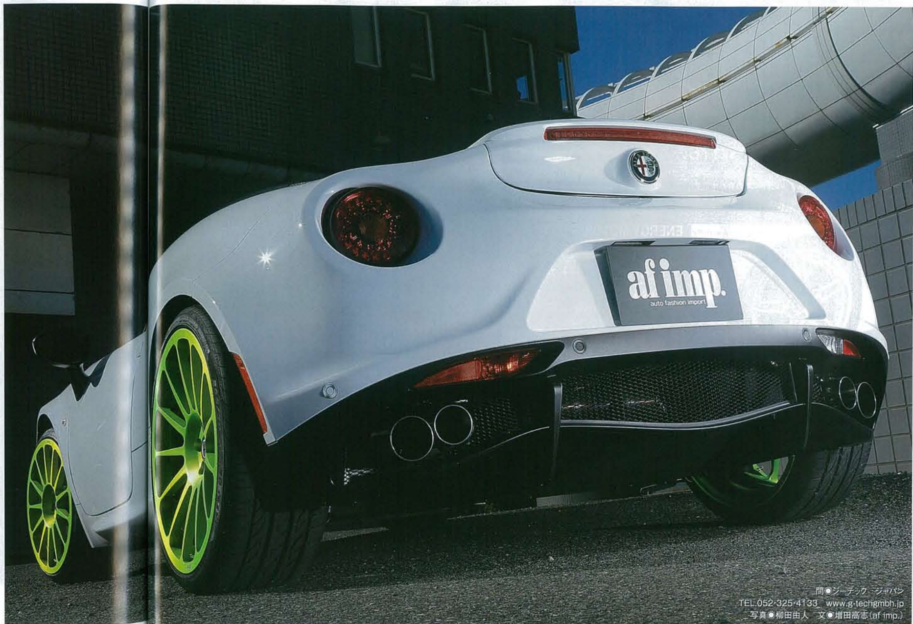
↑ パイプのヨコにセットされている丸みを帯びた黒い物体の中にスピーカーが仕込まれている。デジタルサウンドはスイッチによってオンとオフが設定できる仕組みとなる
