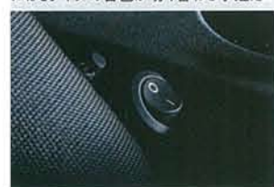
↓ 室内にはサウンドのオンとオフのスイッチと、変更ボタンがセットされる。最終的には6タイプの音色が切り替わる予定だ
